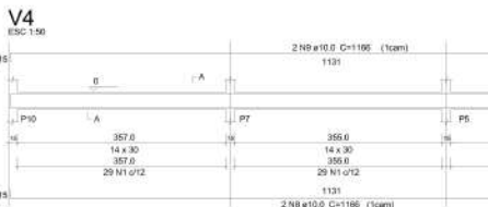
VIGA BALDRAME escala: indicada
